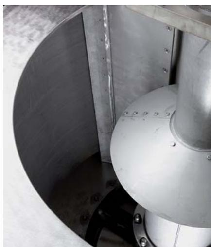
Descargador de un solo eje en posición de descanso (a la izda.) y en posición de descarga (a la dcha.)
