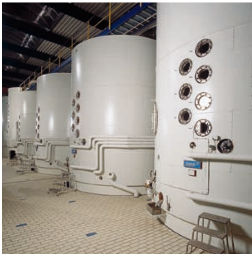
Испарительные вакуум-аппараты периодического действия для белого сахара 1 и 2
