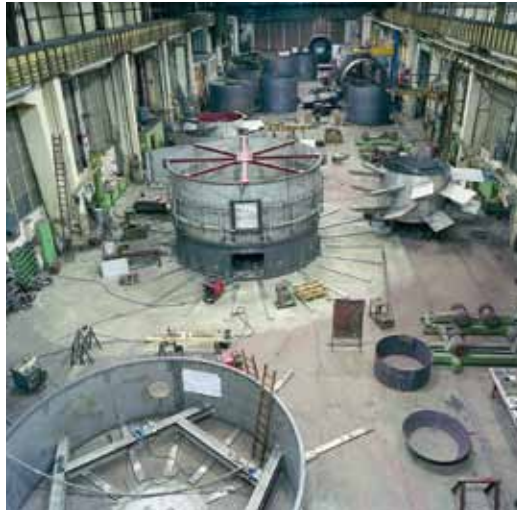
Installations de diffusion de BMA en voie de production
